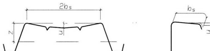
Figura C4.2.25 – Incurvamento delle piattabande
