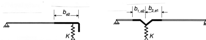
Figura C4.2.31 – Schematizzazione degli irrigidimenti
