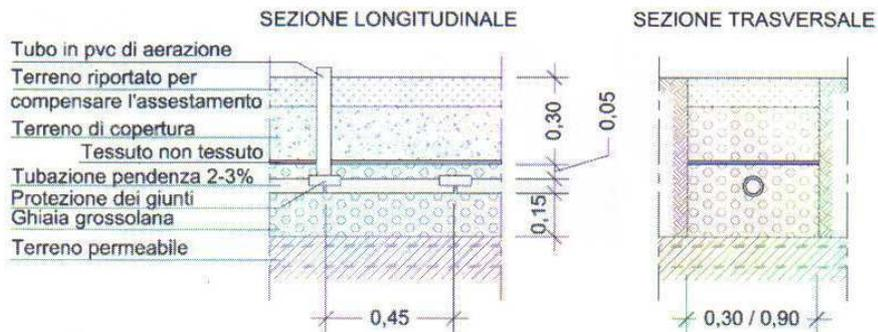
Fig. 5 – schema di trincea per la sub irrigazione nel terreno
