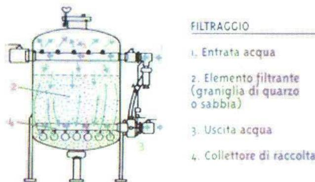
Fig. 9 – Schema di filtro a sabbia
