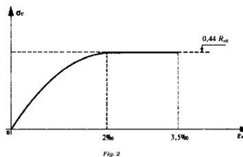
Nel caso in cui sia  $x > h$ , la tensione normale di calcolo risulterà pari a  $0,35 R_{ck}$ .
